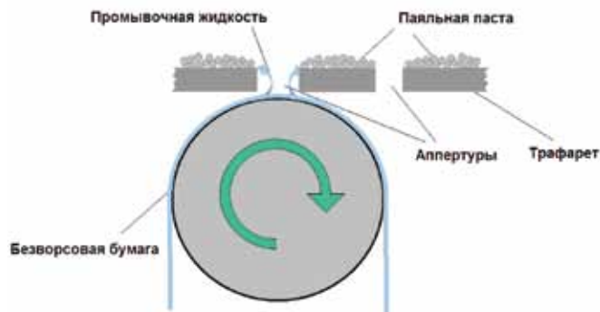
Рис. 4 Проникновение промывочной жидкости через апертюры трафарета
