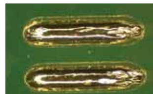
Рис. 7 Результат визуального контроля при отмывке трафарета с использованием Zestron SW
