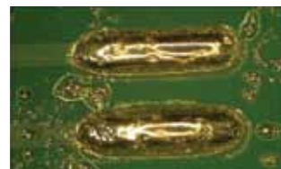
Рис. 5 Результат визуального контроля при отмывке трафарета с использованием изопропилового спирта
